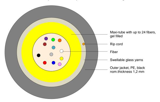
Principle Drawing: A-DQ(ZN)B2Y 1x12 E9U/125 0.34F3.5 + 0.20H18
